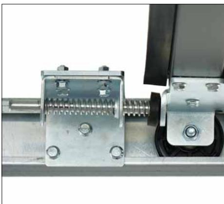
Der neue Federpuffer sorgt für die **Dämpfung** des Torblatts und als Anfahrthilfe für den Antrieb. Neue Laufrollen mit verschleißfester und leise laufender Lauffläche sorgen für eine weitere Dämpfung.
